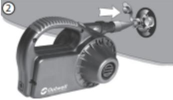
2) Acople la boquilla al extremo de inflado de la bomba. Inserte la boquilla en la válvula y encienda la bomba.
