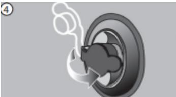
4) Retire completamente la bomba y cierre el tapón exterior. La válvula debe quedar ligeramente hundida hacia el interior.
